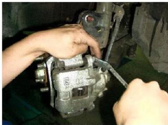
2 拆下煞車分泵固定螺絲
