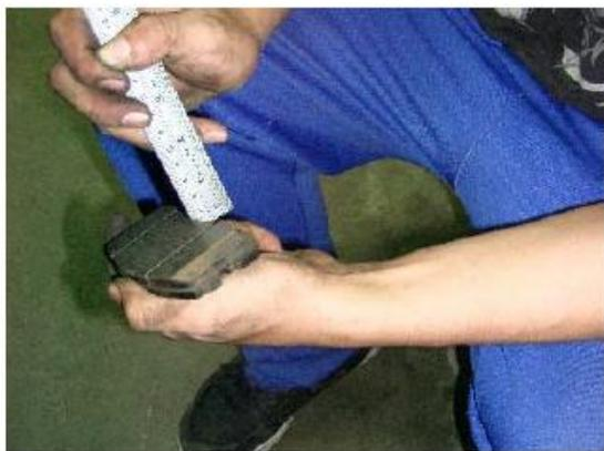
4 量測煞車塊厚度
