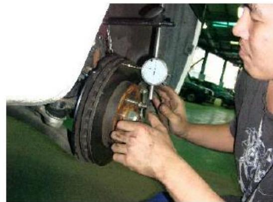
6 量測碟盤偏擺度
