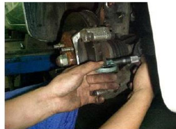
9. 測量碟盤厚度
