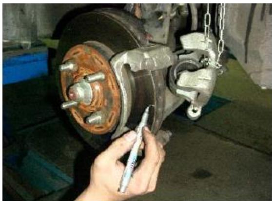
7. 碟盤厚度量測點記號
