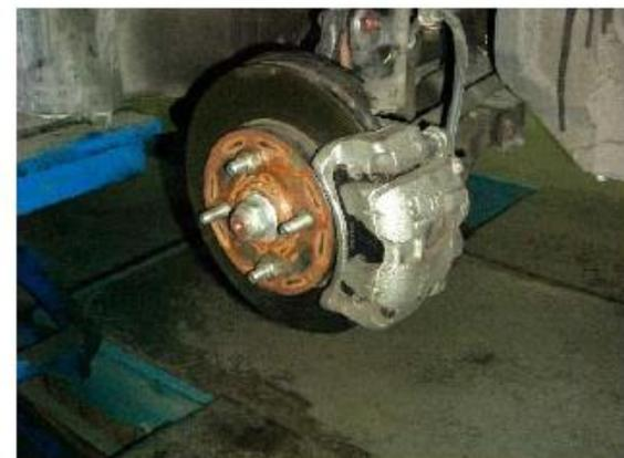
12. 完成碟式煞車檢修
